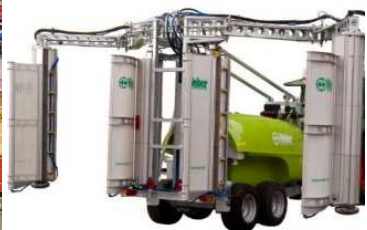
WEBER – descentes avec panneaux récupérateurs
